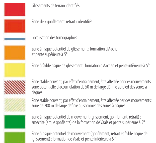
Extrait de la légende de la carte de synthèse définissant les zones à risques de glissement de terrain.
