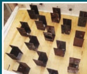
Une charge de 100 kg/m<sup>2</sup> a été répartie de façon uniforme sur la surface. Le centre de gravité des éléments de charge se trouve sur la maîtresse poutre.
