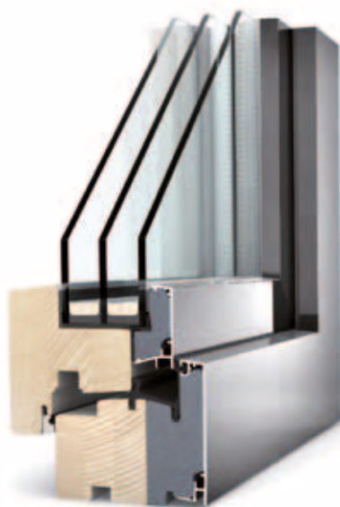
fenêtre Home Pure HF 200 - U_w 0,73 W/m 2 K
