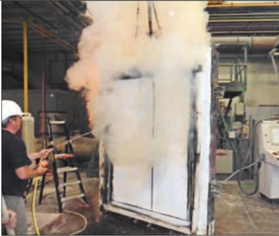
Essai-feu sur un élément CLT + une plaque en silicates de calcium – © Promat International nv
