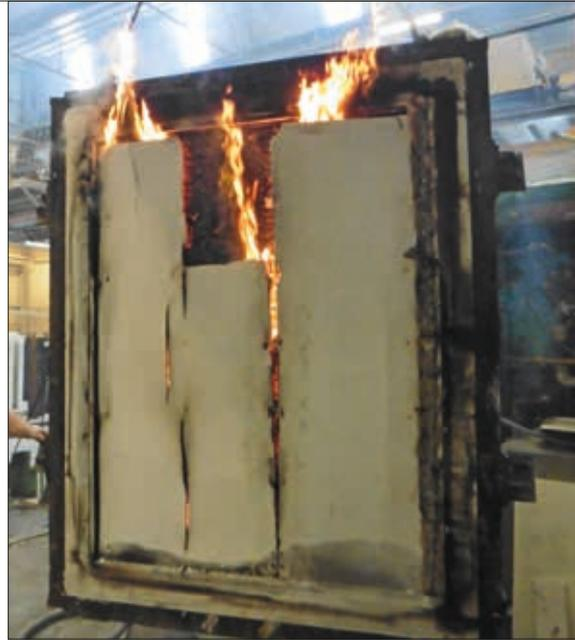
Essai-feu sur un élément CLT + une plaque de plâtre – © Promat International nv
