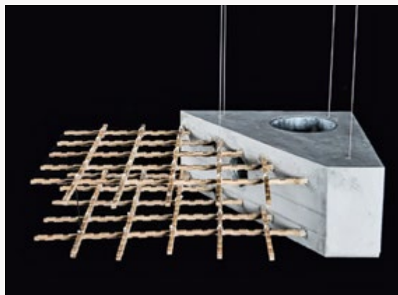
Paillage de bambou pour béton armé
